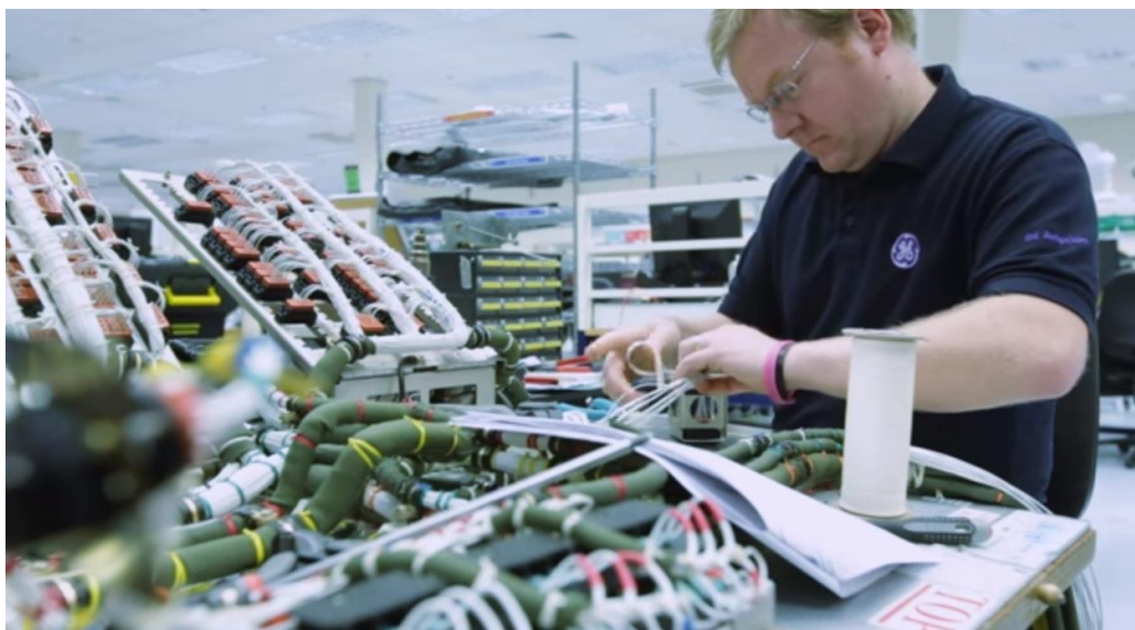
Рисунок 2. Предварительная сборка жгутовых межсоединений для системы распределения электроэнергии ЛА
