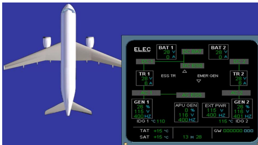
Рисунок 1. Электронное табло, отображающее состояние системы электроснабжения ЛА (шин постоянного и переменного напряжений)
